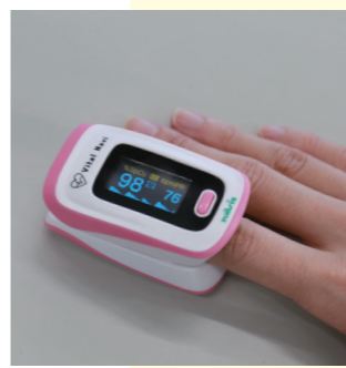
パルスオキシメーターで血液中の酸素濃度と心拍数を計測できます
